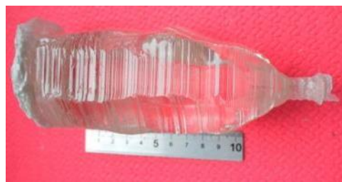
2015 \text{Zn}^{100}\text{MoO}_4 crystal boule ~ 1.4 kg
