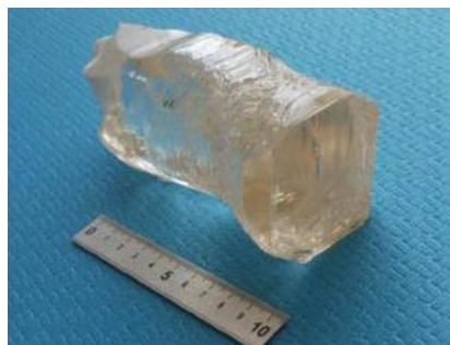
2013 \text{ZnMoO}_4 crystal boule ~ 1.5 kg
